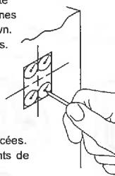
Placez le gabarit de la gâche sur le chambranle; alignez les axes avec les lignes tracées. Marquez les quatre points de centrage.
